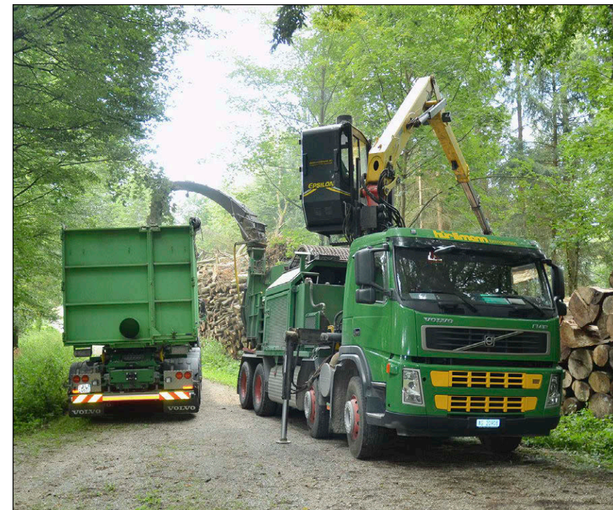
Auf dem Lastwagen rechts werden die Baumstämme zu kleinen Schnipseln geschreddert und dann in den Container links befördert.
